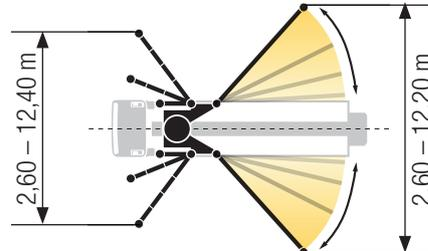
Las dimensiones dependen de la configuración. La anchura de apoyo se refiere al centro de la pata de soporte. Diámetro de la placa de soporte giratoria 350 mm.
